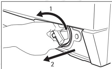
5. Когда контейнер наполнится водой, установите сливную трубку на место и вылейте воду из контейнера. Повторите эту операцию 4 или 5 раз до тех пор, из сливного насоса не перестанет вытекать вода.
